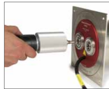
4. Analysenleitungen einstecken und mit der Überwurfmutter sichern
