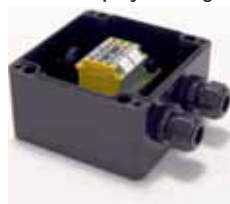
Art.-N° WZX188EX Boîte de dérivation Ex e (réseau) Marquage : Ⓜ II 2G Ex e IIC T6 Ⓜ II 2D Ex tD A21 T+80°C IP66 Equipement : 2 vissages, 2 vis borgnes, 6 bornes Dimensions (LxHxP) : 122 x 120 x 90 mm
