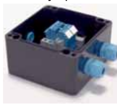
Art.-N° WZX189EX Boîte de dérivation Ex i (sondes) Marquage : Ⓜ II 2G Ex ia IIC T6 Ⓜ II 2D Ex tD A21 T+85°C IP66 Equipement : 3 vissages, 1 vis borgne, 7 bornes Dimensions (LxHxP) : 122 x 120 x 90 mm
