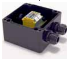
Art.-Nr. WZX188EX Anschlusskasten Ex e (Netz) Kennzeichnung: Ⓜ II 2G Ex e IIC T6 Ⓜ II 2D Ex tD A21 T+80°C IP66 Ausstattung: 2 Verschraubungen, 2 Blindstopfen, 6 Klemmen Abmessungen (BxHxT): 122 x 120 x 90 mm
