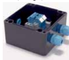
Art.-Nr. WZX189EX Anschlusskasten Ex i (Sensoren) Kennzeichnung: Ⓜ II 2G Ex ia IIC T6 Ⓜ II 2D Ex tD A21 T+85°C IP66 Ausstattung: 3 Verschraubungen, 1 Blindstopfen, 7 Klemmen Abmessungen (BxHxT): 122 x 120 x 90 mm
