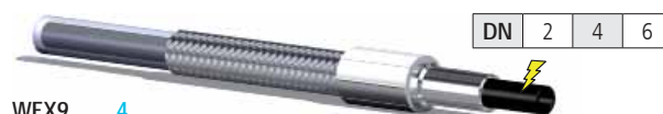
WEX9__4 Tuyau de base PTFE avec raccords tube acier inox 1.4571 et tuyau PTFE interchangeable (dépassant de 500 mm des deux cotés)
